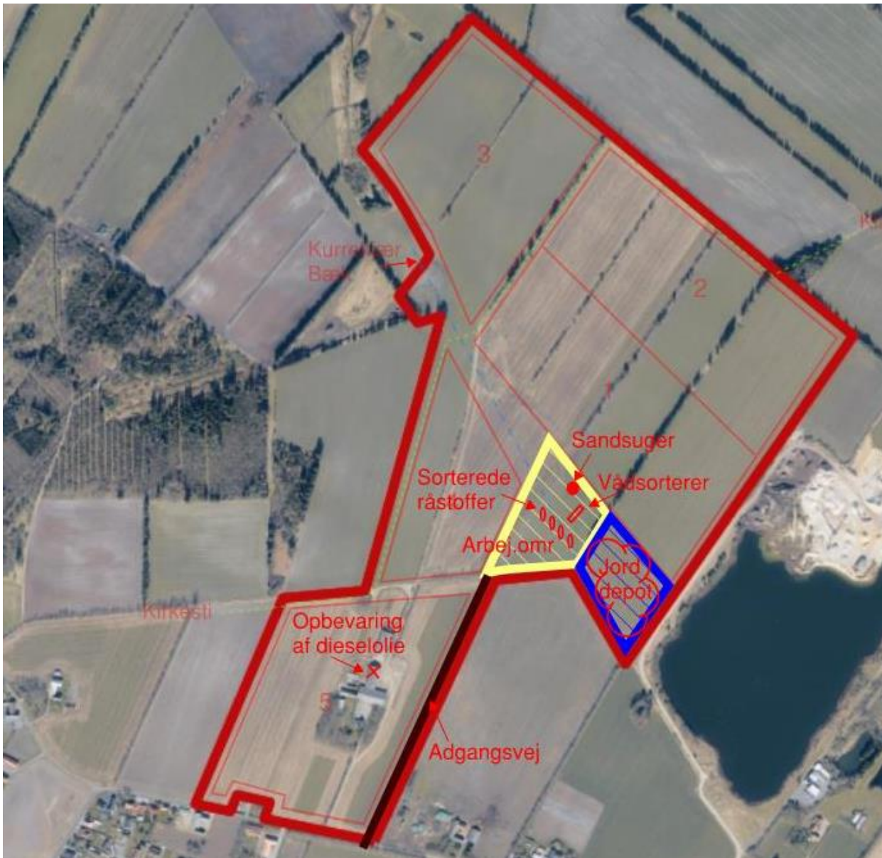
Figur 8. Markering af område til arbejdsplads og adgangsvejen og jorddepot. Specifik indretning af arbejdspladsen kan variere når felt 4 og særligt felt 5 udnyttes.
